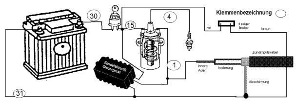
Auf dem Bild sehen Sie den Anschluß der Versorgungsspannung (rotes und braunes Kabel an 4pol Stecker) und des Zündimpulskabels.
